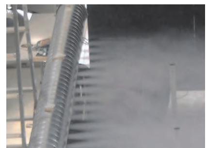
Rauchversuch am Düsenrohr
